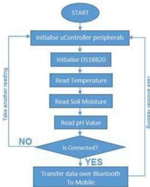
Fig. 2. Firmware Flowchart
